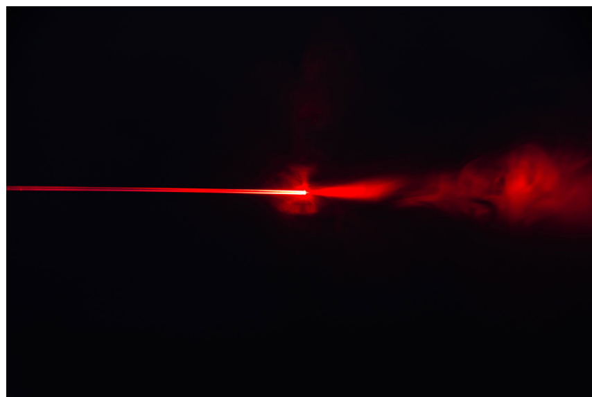
Световод с плоским торцом
